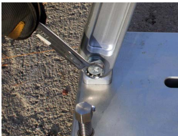
g. Dra åt den nedre bulten på bakstödet.
