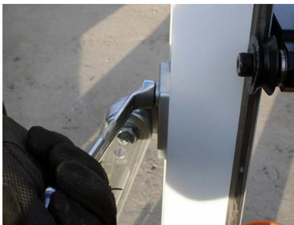
e. När rälisen är i rätt position, dra åt bulten ordentligt.
