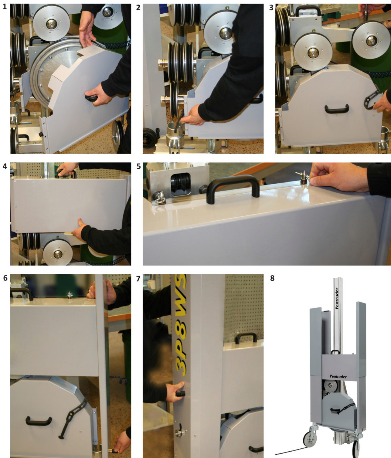
Fijando los protectores de la cortadora de hilo Pentrunder 3P8.
