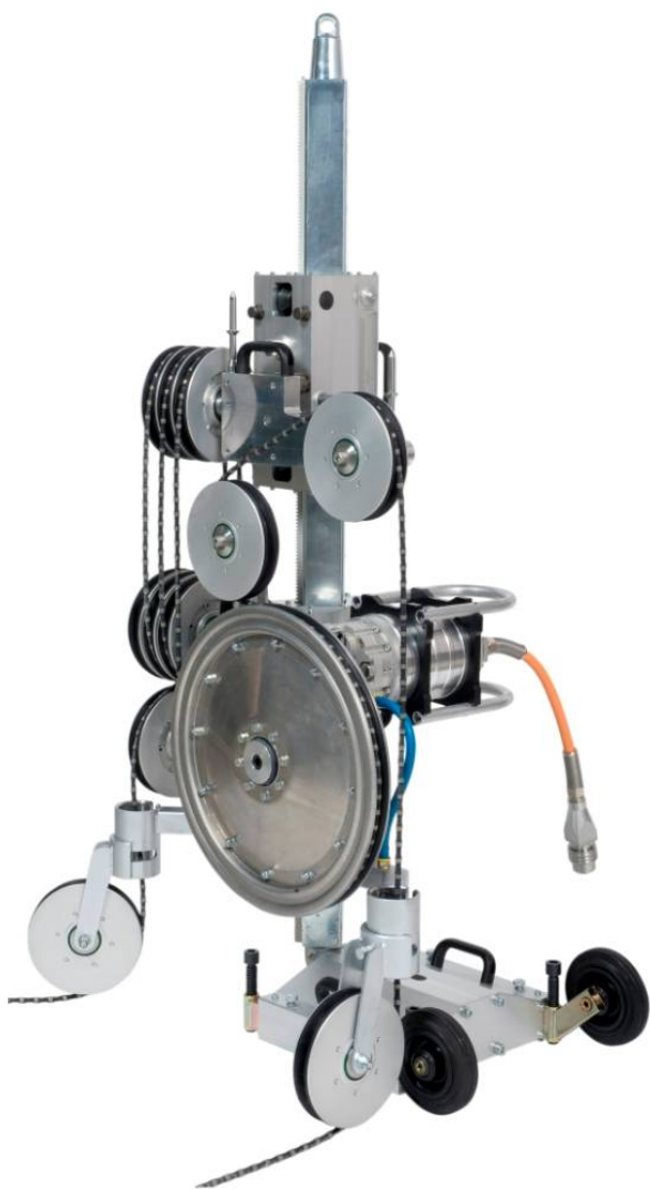
Pentruder 3P8 HF-vajersåg byggd på rigg med 70 mm pelarsystem
