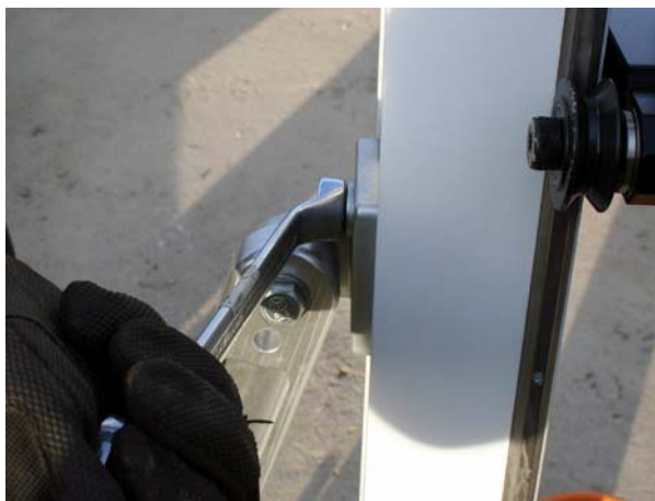
e. Wenn die Schiene aufrecht ist, ziehen Sie die Schraube ganz zu.
