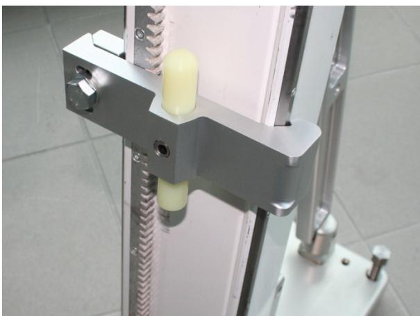
El tope puede usarse para marcar el final de carrera durante la perforación.
