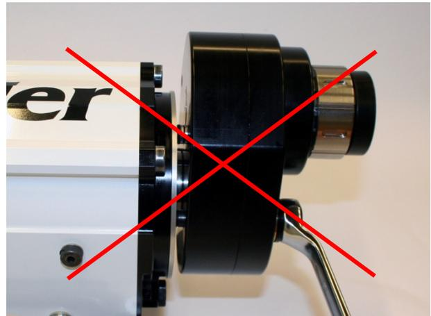
d. Compruebe que la caja de cambios ha entrado correctamente, no dejando hueco entre el motor y la caja de cambios, antes de apretar los tornillos con una llave del 19 mm
