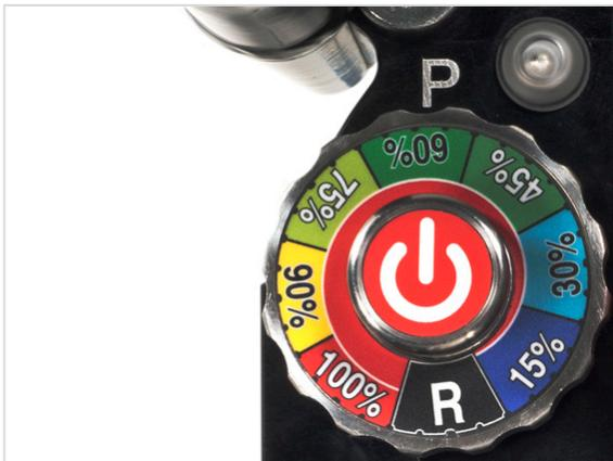
Para reducir la carga/potencia, p. e. cuando se perfora con un diámetro pequeño o con segmentos muy finos, seleccionar la potencia con el Dial de potencia y presione el botón para activar esta función. El dial está graduado en los niveles: 15 / 30 / 45 / 60 / 75 / 90 / 100 % y R. Solo se usa si el motor viene equipado con avance automático.
