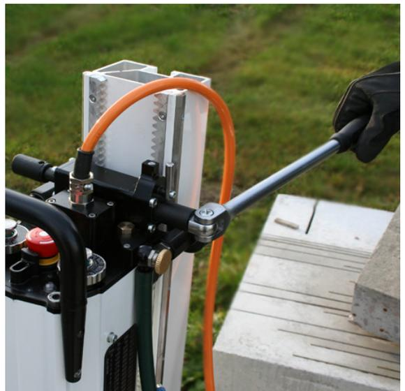
e. Use una manivela HK-1 o una barra de cuadrado de 400 mm 1/2" para mover arriba y abajo el motor sobre el rail.
