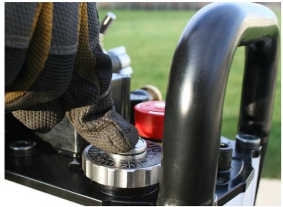
a. Cuando el botón Motor ON/OFF se ha pulsado y el eje comienza a girar, el M-LED ayudara al operario a perforar con la carga optima, p. e. para aplicar el avance optimo y utilizar la potencia total del motor. Ver cuadro siguiente.
