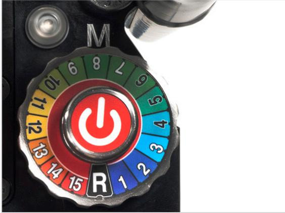
Seleccione la velocidad de giro deseada con el Dial-M. La velocidad adecuada del eje varía en función de la corona, tipo de hormigón y cantidad de armaduras de refuerzo.
