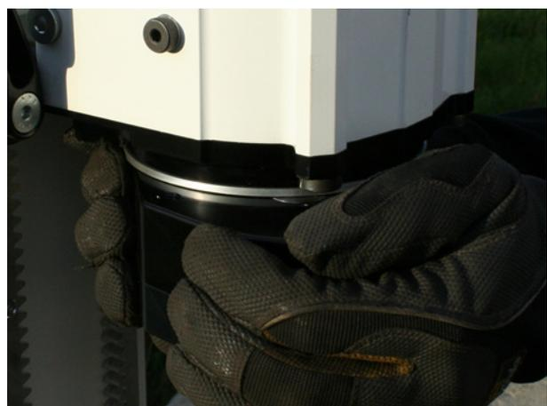
f. Gire la caja de cambios hasta la posición deseada y apriete los tornillos de nuevo.
