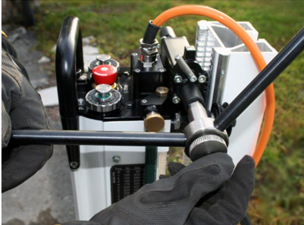
a. Coloque el manillar en cualquiera de los dos lados del carro y apriételo manualmente.
