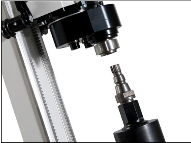
a. Enrosque la corona en el adaptador, asegúrese de que las roscas están limpias y ligeramente engrasadas. Inserte el adaptador en la caja de cambios.
