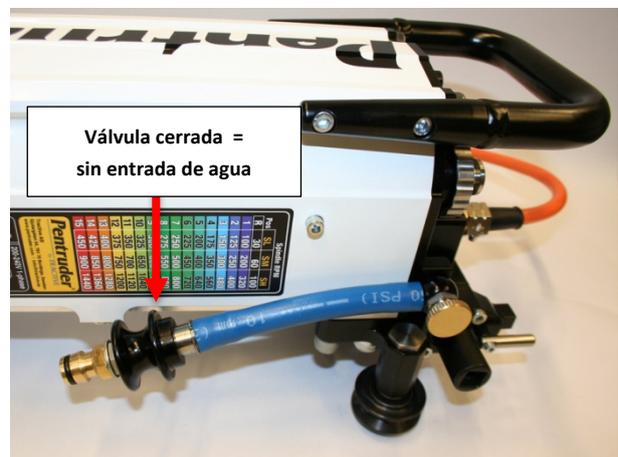
El caudal de agua puede ajustarse con la válvula. En la izquierda la válvula esta abierta = permita la entrada de agua (válvula hacia arriba) en la derecha esta cerrada = sin entrada de agua (válvula hacia abajo).
