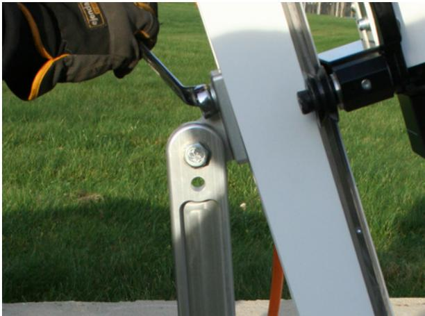
c. Afloje el tornillo de la brida superior e incline el raíl a la posición deseada adelante o atrás.
