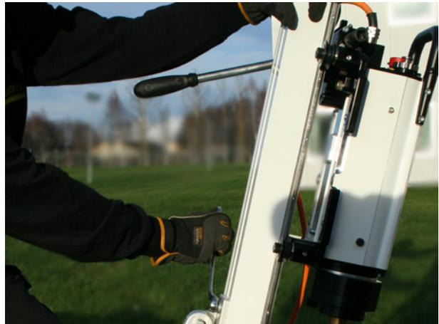
d. Apriete el tornillo de la brida superior y los tornillos superior e inferior del soporte.
